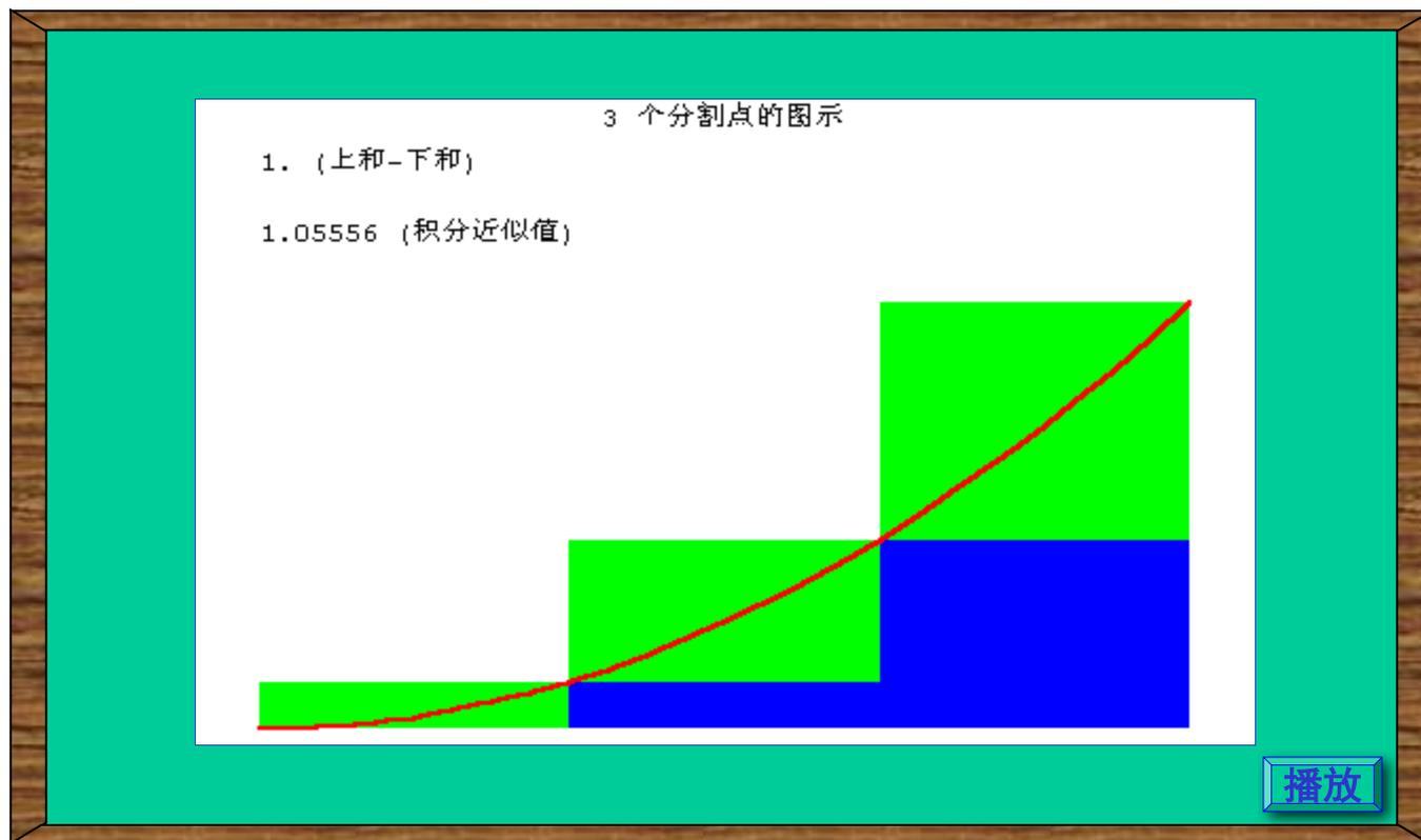
曲边梯形如图所示，在区间  $[a, b]$  内插入若干个分点， $a = x_0 < x_1 < x_2 < \cdots < x_{n-1} < x_n = b$ ，把区间  $[a, b]$  分成  $n$  个小区间  $[x_{i-1}, x_i]$ ，长度为  $\Delta x_i = x_i - x_{i-1}$ ；在每个小区间  $[x_{i-1}, x_i]$  上任取一点  $\xi_i$ ，
